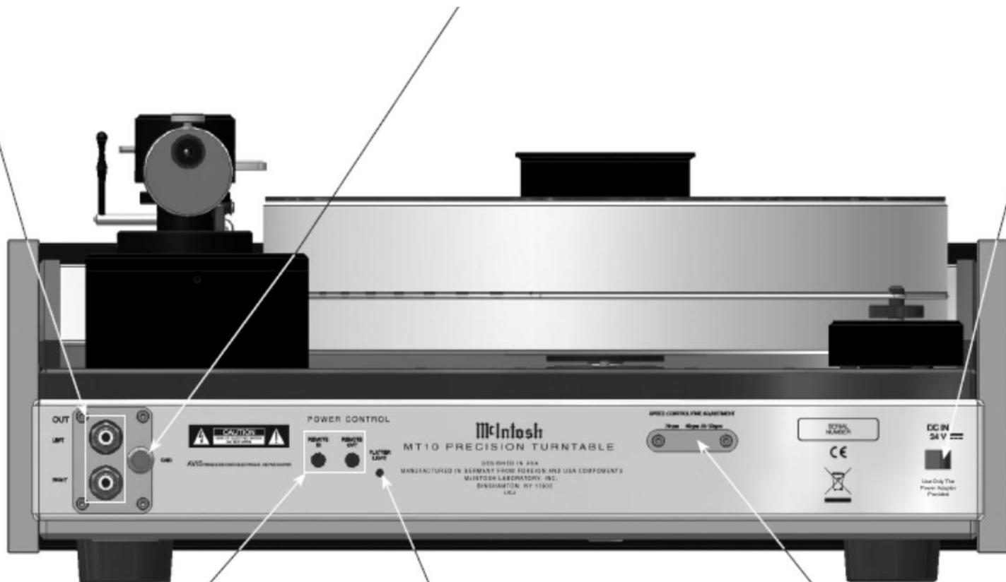
Разъем POWER CONTROL IN/OUT принимает сигналы включения/откл от компонента и вкл/отк индикаторы на Фронтальной информационной панели
