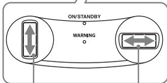
Регулировка вертикального положения
