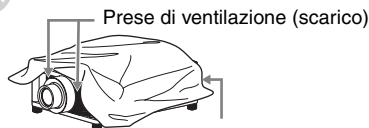
Prese di ventilazione (aspirazione)
